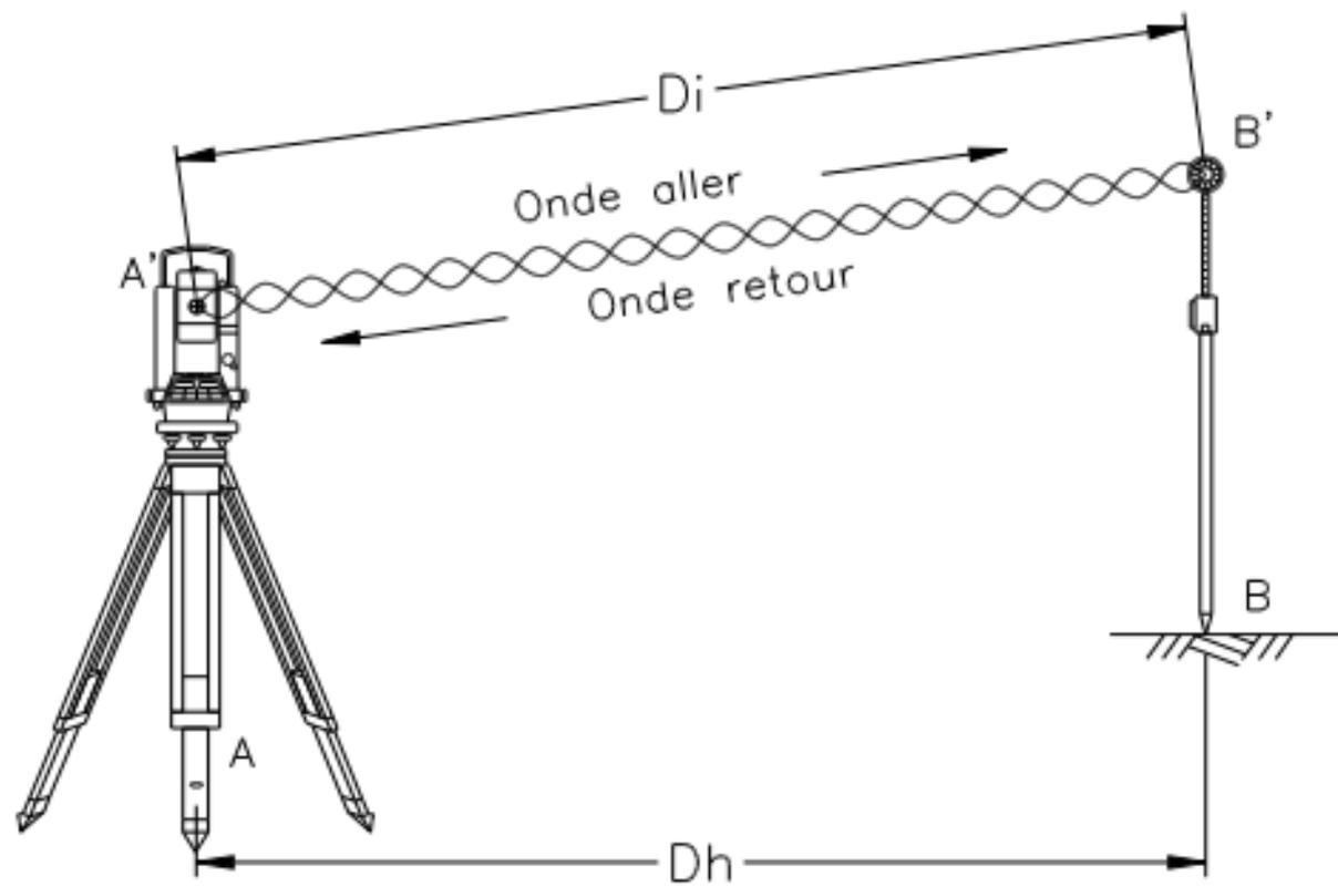
**Fig. 4.15. : Mesure de distance avec un IMEL**
