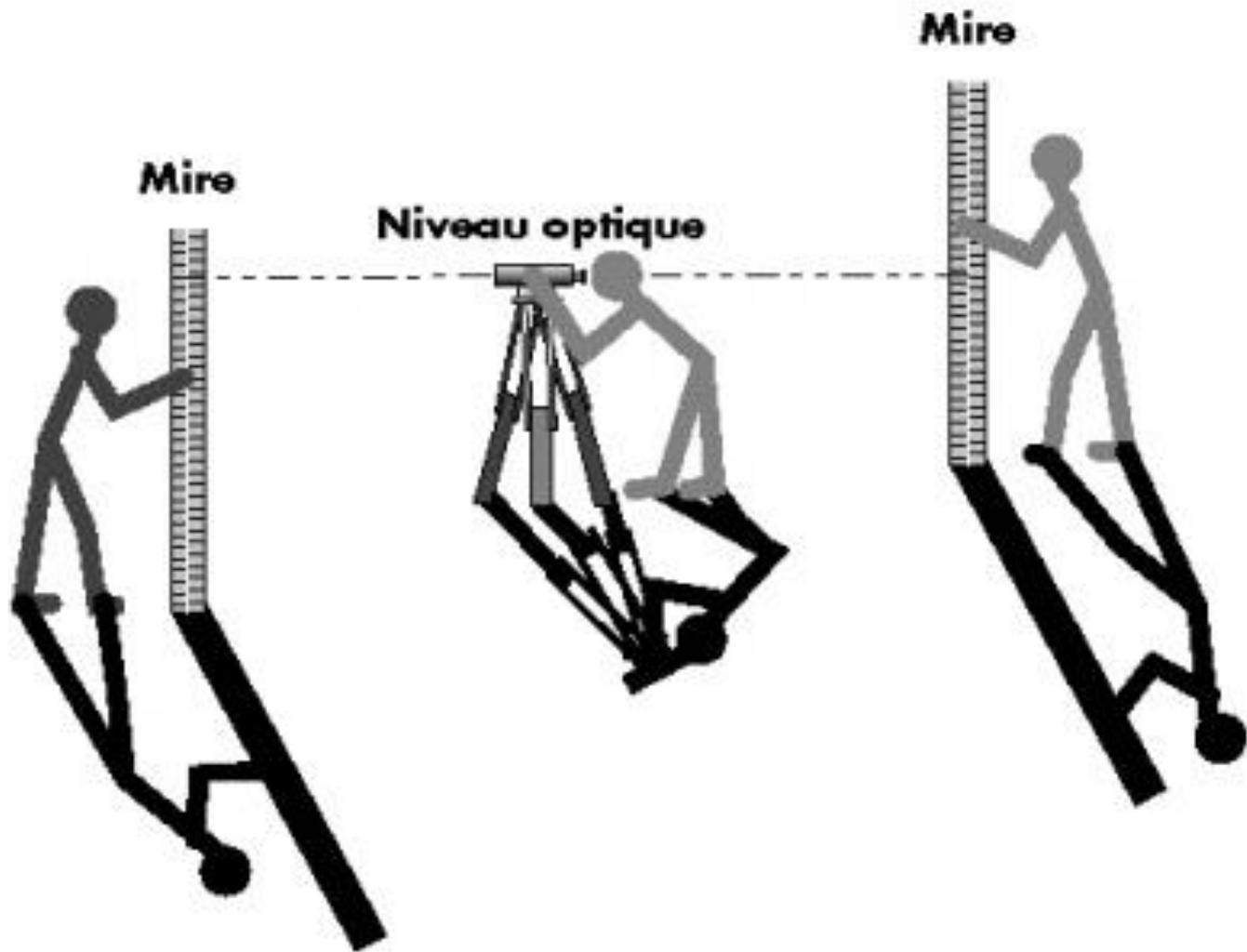
Principe de mesure direct géométrique
